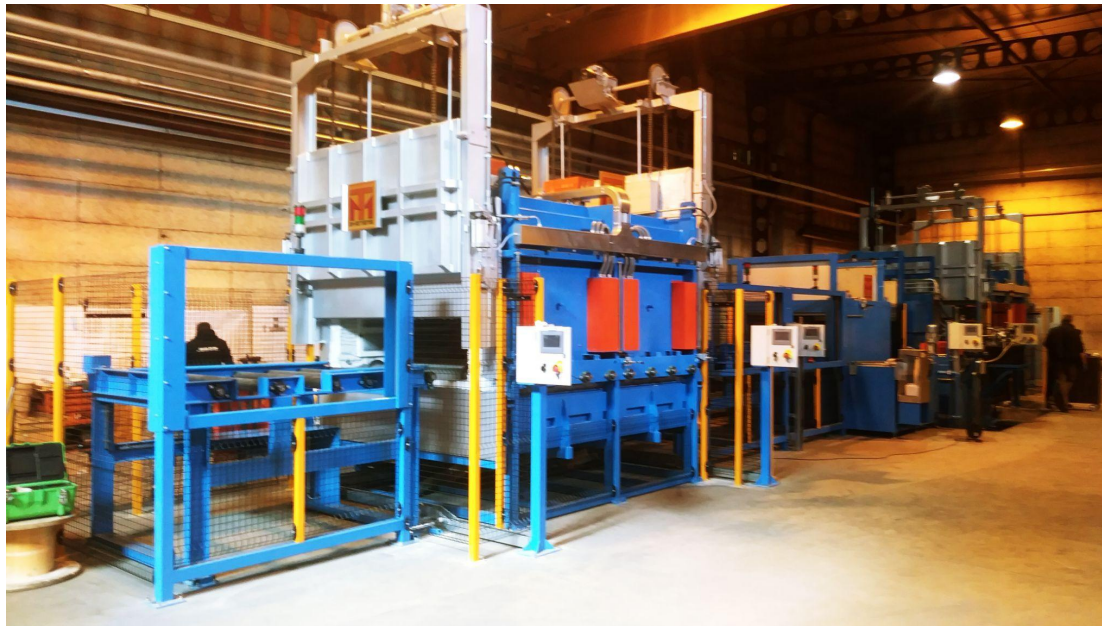
Linea automatica a rulli per tempra e rinvenimento
